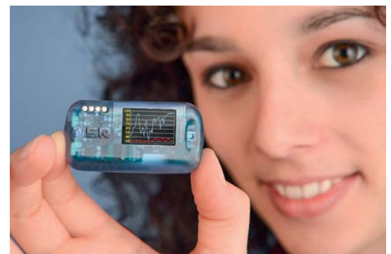
Die MSR-Mini-Datenlogger finden überall Platz und können über lange Zeit hinweg Daten über die herrschenden Umgebungsbedingungen aufzeichnen.
